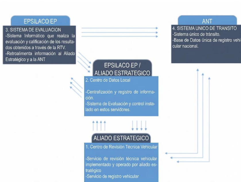
Figura 4. Componentes del Sistema de Revisión Técnica Vehicular
